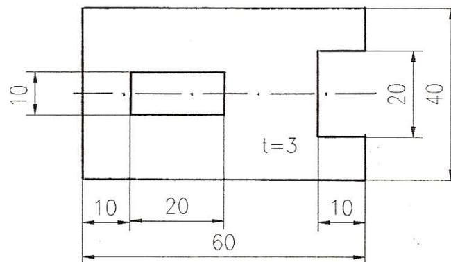
Geschlossene Maßketten - über eine ganze Werkstückseite - sollen wegen der dabei auftretenden Fehlerhäufigkeit und der ungünstigen Übertragbarkeit der Maße auf das Werkstück nicht verwendet werden. Ist dies in besonderen Fällen nicht möglich, wird ein Maß in Klammern gesetzt.
